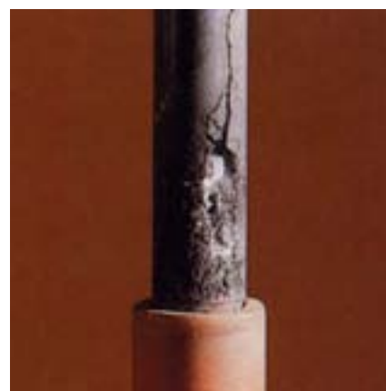
Povrch PE-materiálu (černý) po 48 hod. zkoušení
